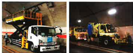
設備清掃・点検 トンネル側壁清掃
